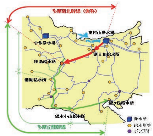
多摩地域の送水管ネットワーク
